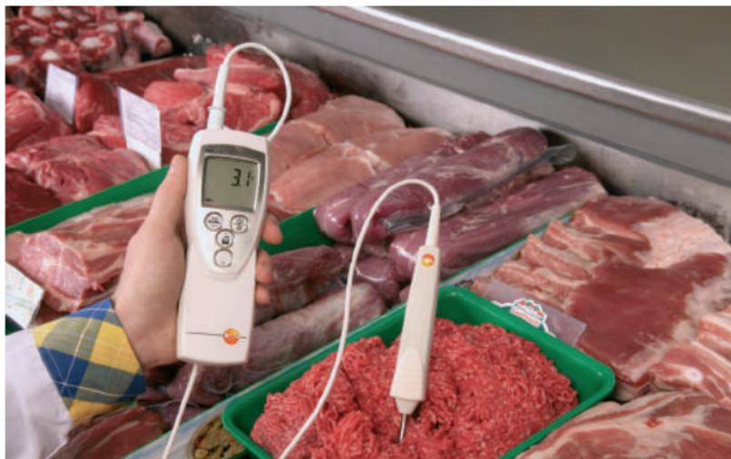
Fig. 18: Utilizzo di testo 112 con sonda a penetrazione
