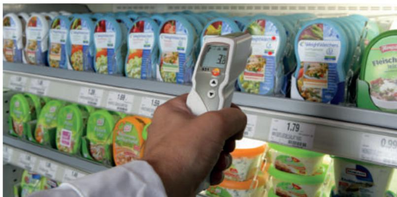
Fig. 5: Misura a infrarossi della temperatura di superficie degli alimenti
