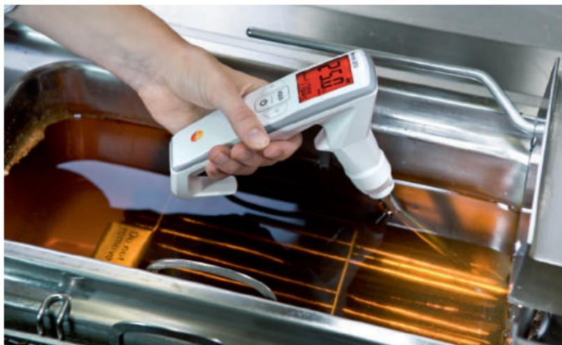
Fig. 11: Misura del valore TPM nell'olio di frittura con testo 270
