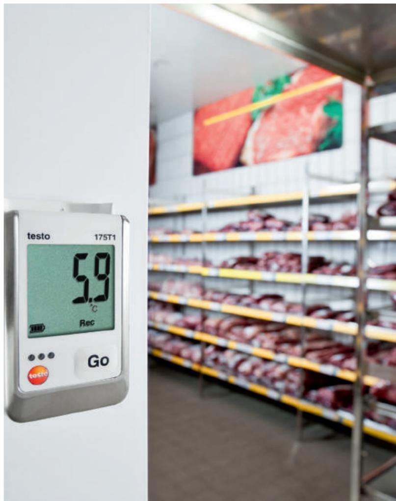
Fig. 16: Monitoraggio della temperatura in un locale refrigerato con testo 175T1
